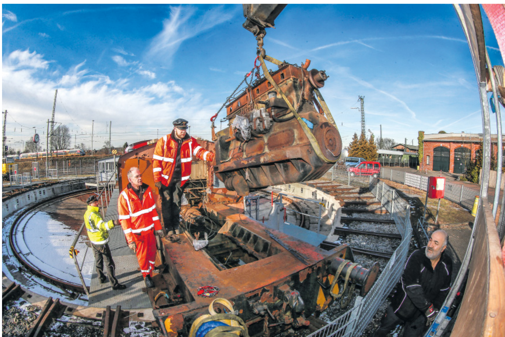
Schätzchen: Der 1,3 Tonnen schwere Motor hängt am Haken des Ladekrans. In roter Warnkleidung überwachen Marco Riffelmann (v. r.) und Dietmar Plischke die Arbeiten. In drei Jahren soll das 77 Jahre alte Diesellaggregat die Rangierlok wieder antreiben.
