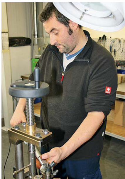
Injektorenprüfung: Nicht immer ist es notwendig, alle Injektoren zu tauschen.
