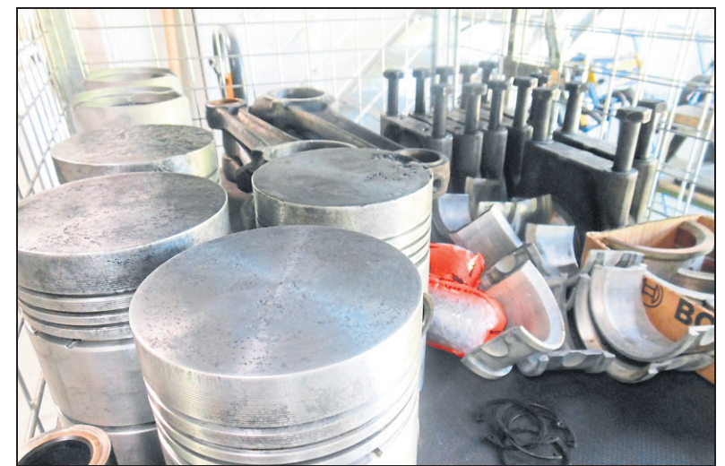
Gute Mischung: Aus solchen Einzelteilen schraubt man einen Motor mit 128 PS und viel Kraft für den Rangierdienst zusammen.
