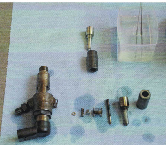
Zerlegter Piezoinjektor, bei dem der Düsen-einsatz erneuert wird.
