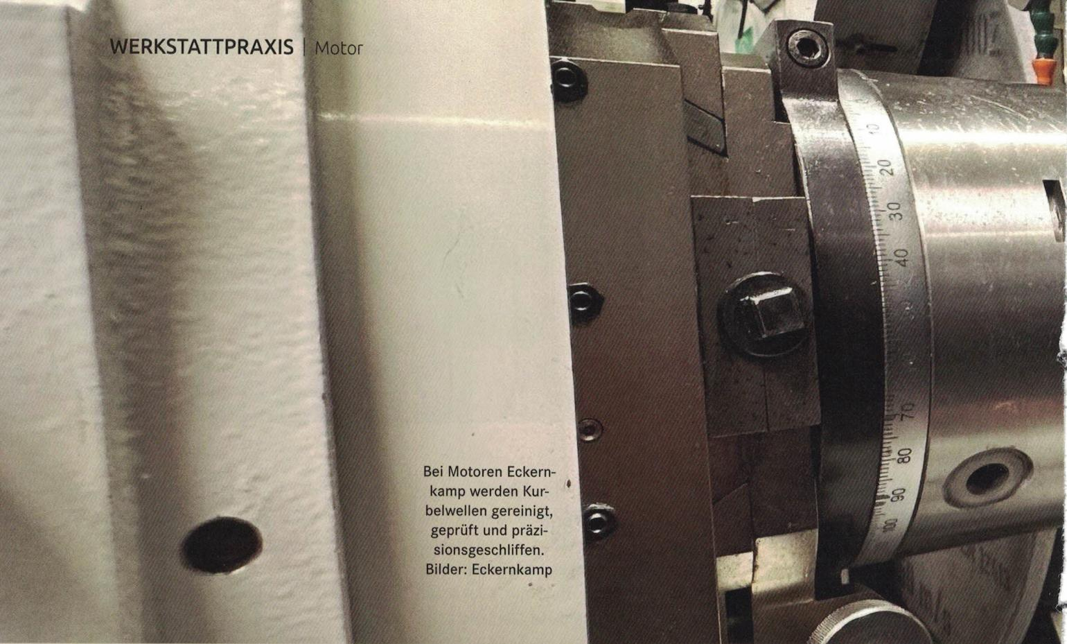
Bei Motoren Eckernkamp werden Kurbelwellen gereinigt, geprüft und präzisionsgeschliffen.
